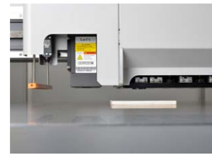
Réglage automatique de la hauteur de la tête
