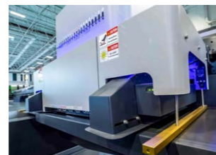
Chariot à pression avec capteur de collision
