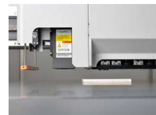
Réglage automatique de la épaisseur du support
